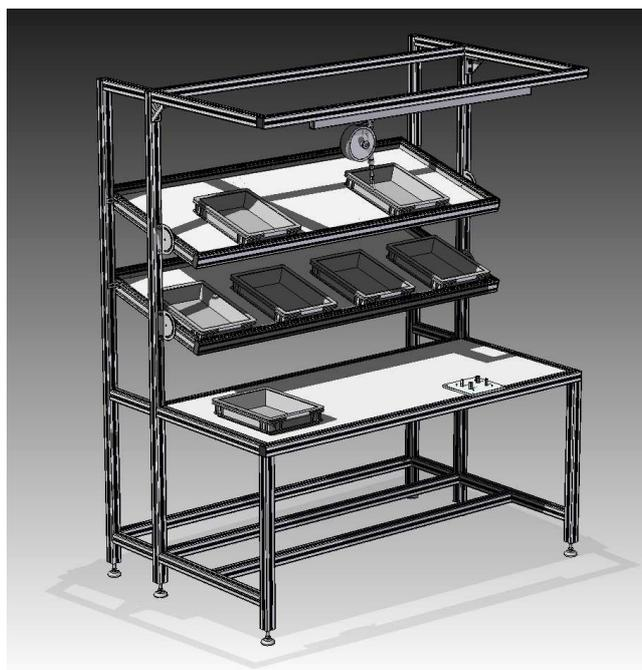
Ogni banco può essere progettato per alloggiare strumentazione o attrezzature specifiche, integrando anche alloggi per Pc, mensole per tastiere, supporti per monitor, pedalieri per azionamento strumenti.
